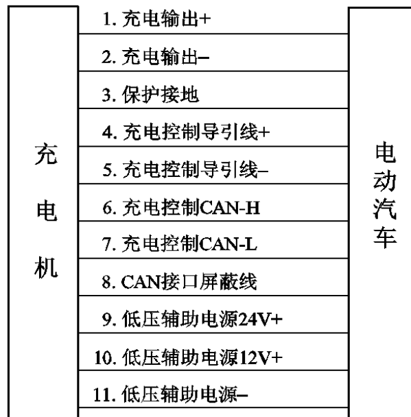
图1 充电机与电动汽车蓄电池系统的连接
